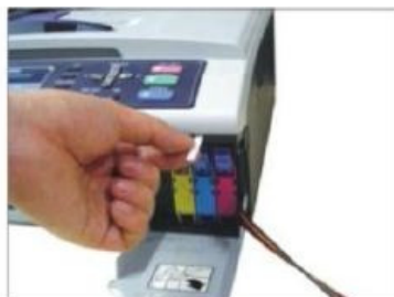
Schneiden Sie aus einem Stück Pappe einen kleinen Streifen, falten ihn zu einem kleinen Bündel und stecken ihn in den Hebeleinlass...
