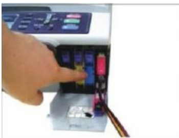
Öffnen Sie die Abdeckung des Druckers und setzen die Patronen ein.
