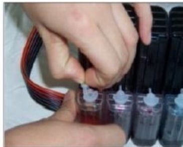
Entfernen Sie die kleinen Gummistopfen...
